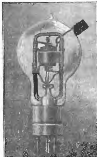
Valvola tipo D V 2, di trasmissione per potenza fino a 50 watt, speciale per piccole lunghezze d'onda.
